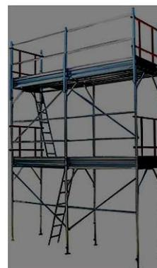
I ponteggi devono essere controventati opportunamente sia in senso longitudinale che trasversale. Devono essere predisposti idonei sistemi di accesso ai piani di lavoro al fine di evitare la salita e la discesa lungo i montanti.
