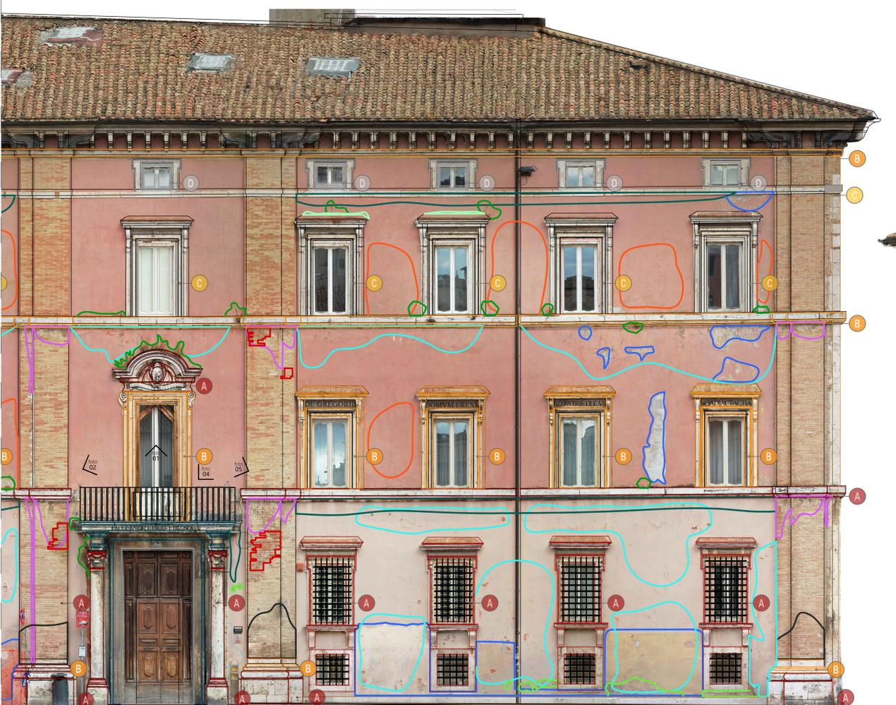
P1 PALAZZO MANZONI - RILIEVO DEL DEGRADO SU BASE GEOMETRICA PROSPETTO 1 (PBSt:P06.E07.01.PR1.)
