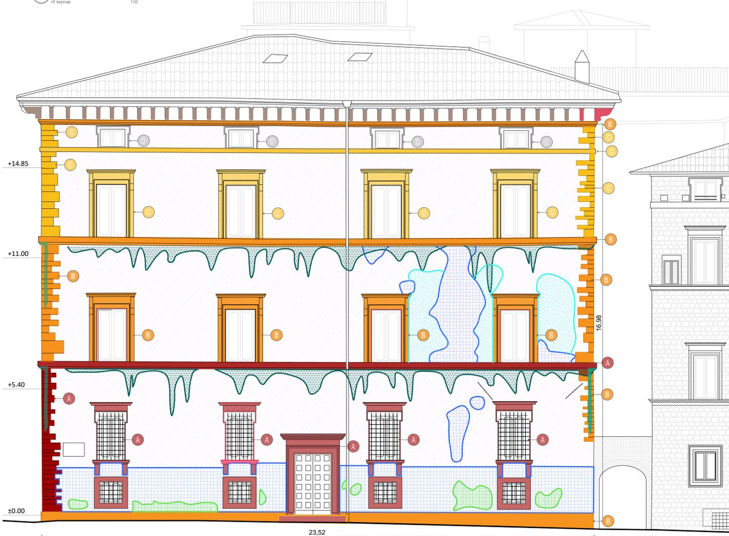
P3 PALAZZO MANZONI - RILIEVO DEL DEGRADO SU BASE GEOMETRICA PROSPETTO 3 (PBSs:P06.E07.01.PR.)
