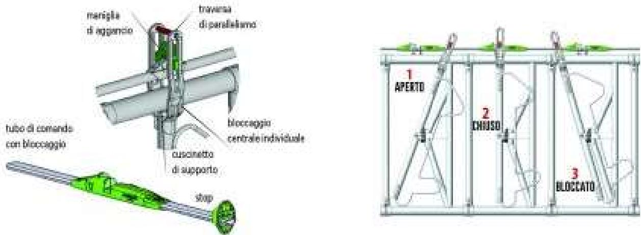
Fig. – Schema rastrelliera autocatturante
