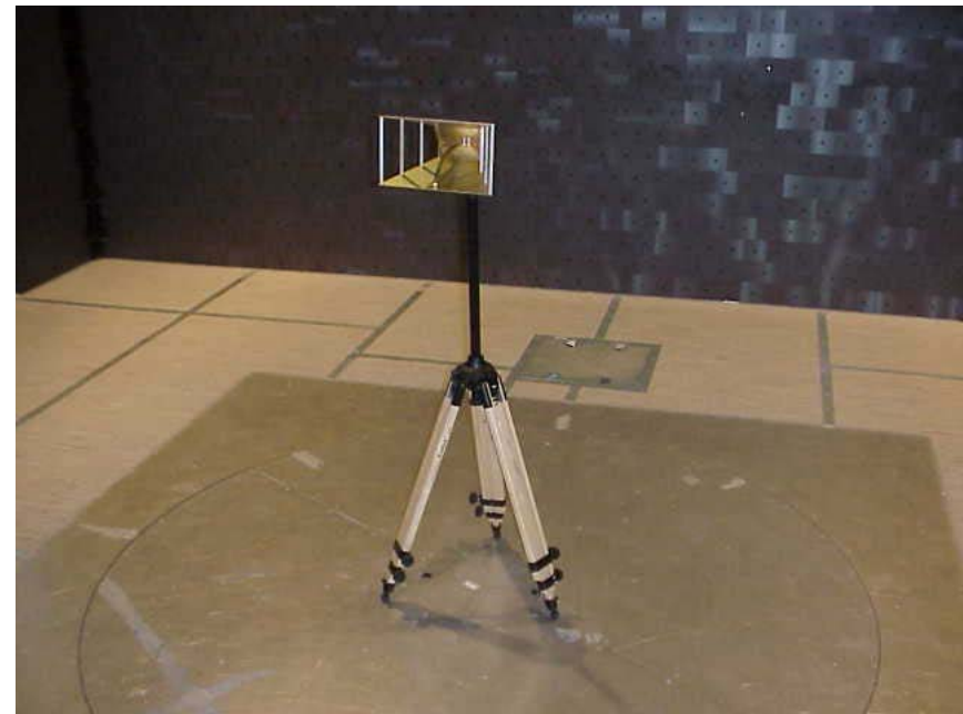
Antenna “horn” utilizzata per misurare o irradiare campi elettrici tipicamente nella banda 700 MHz – 18 GHz
