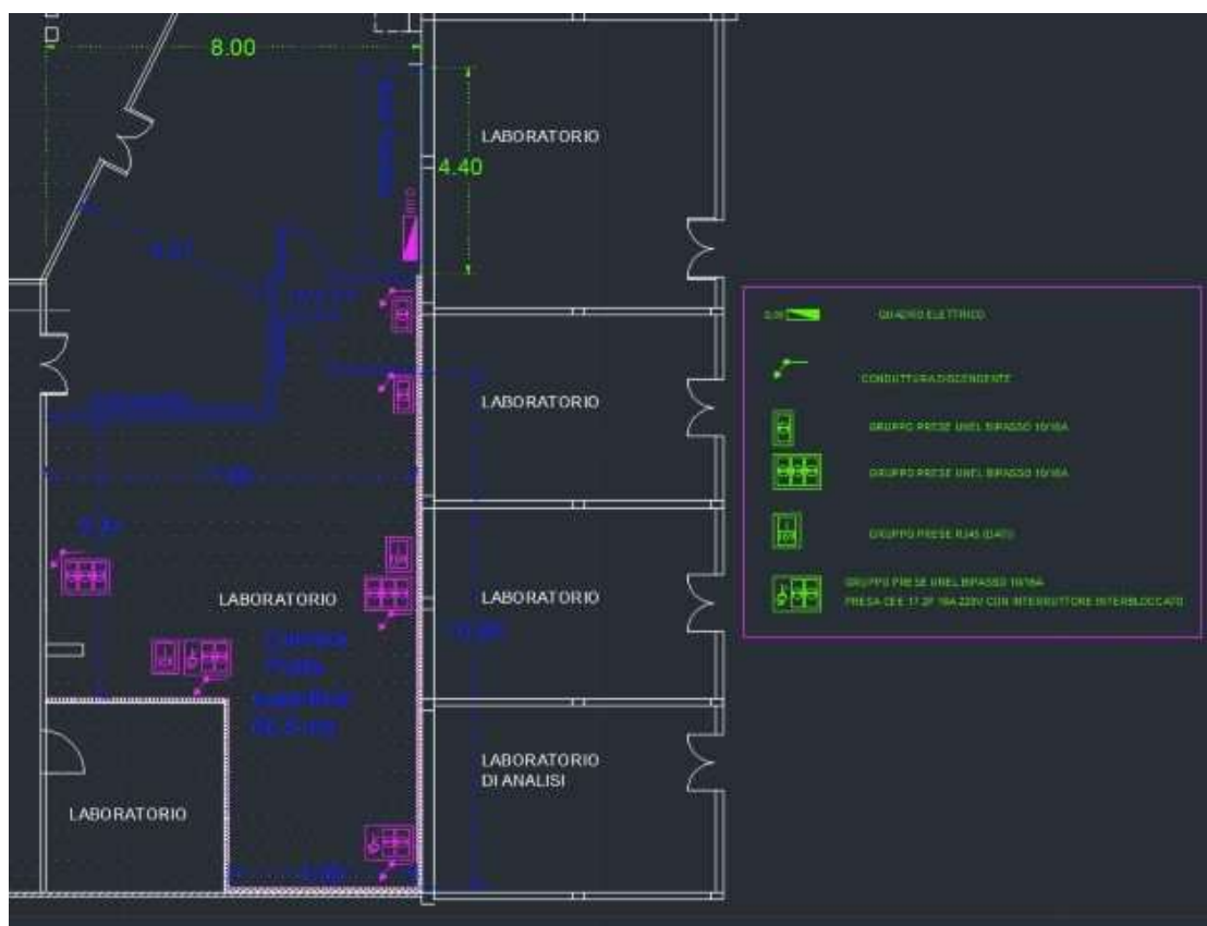
Figura 1: Layout indicativo della camera pulita e aree limitrofe. Le dimensioni riportate si intendono in metri.
