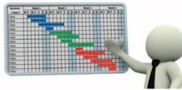
Il diagramma di Gantt è uno strumento che serve per pianificare i tempi di realizzazione del progetto e per verificare, in itinere, il rispetto degli stessi.
